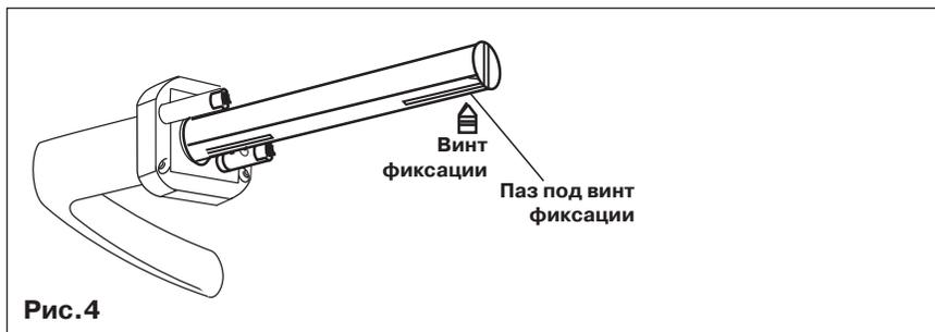
Квадрат должен проходить через отверстие в защелке или замке и быть расположен так, чтобы паз под фиксирующий винт находился снизу (Рис 4). Установите ручки на квадрат. Отметьте местоположение отверстий под крепёж и снимите ручки.
