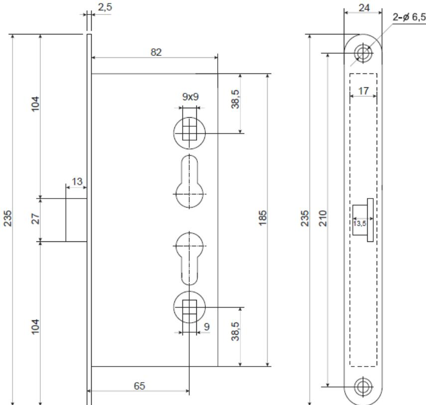
**Идентичные габаритные размеры с противопожарными замками Avers 2000 и Apecs 3000**
